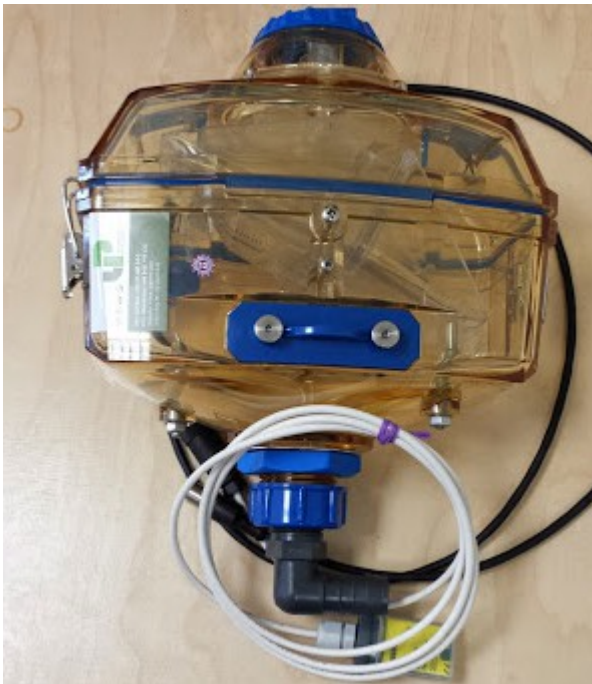
Abb: Kippzähler mit Hobo Pendant-Logger
